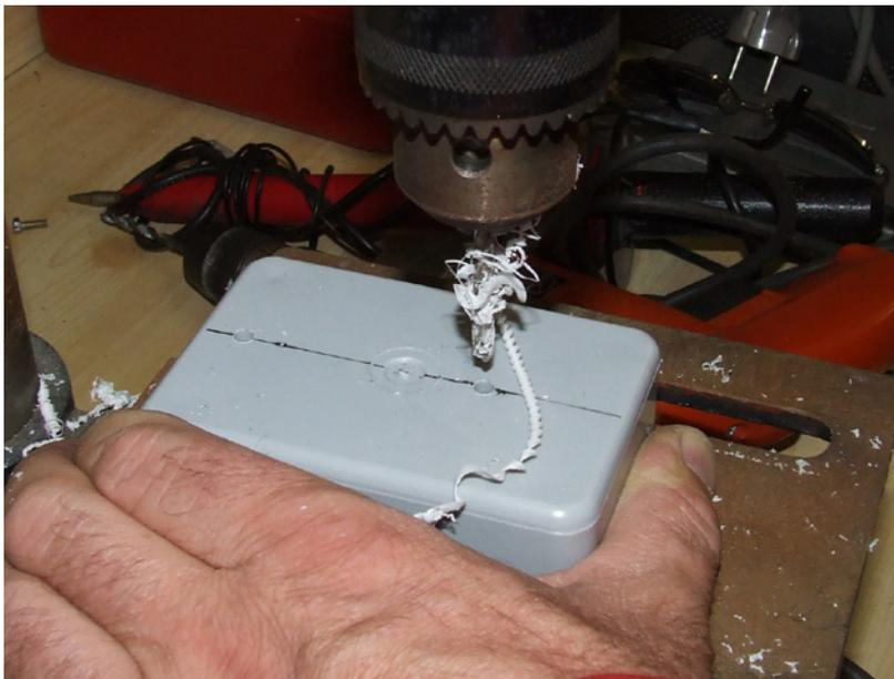
Perçages du fond de boîtier et des cotés, avec une fraise étagée.
