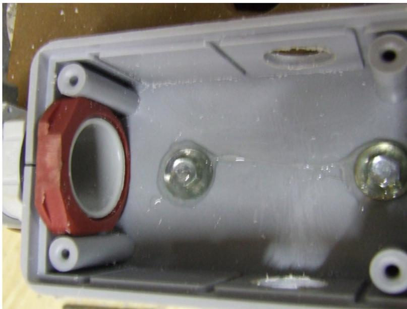
Collage des vis de fixation au fond du boîtier à l'Araldite (pas top) et soudure des bouchons d'extrémité du dipôle.
