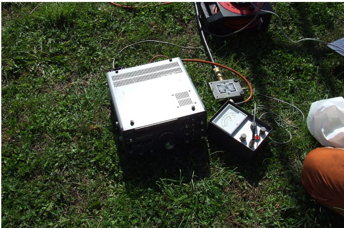
Mesure du SWR (144.250) à la sortie du coupleur 1.2/1
